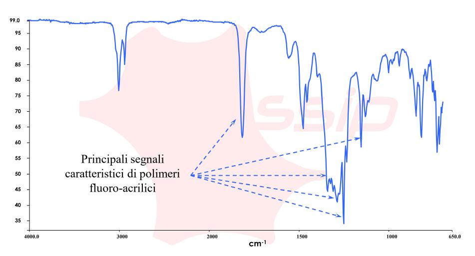
Spettro IR di un prodotto impermeabilizzante a base di polimeri fluoro-acrilici.
