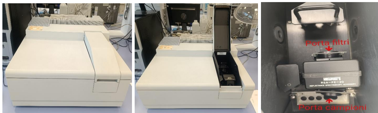
Fig.1-2-3 Spettrofotometro e sfera integratrice
