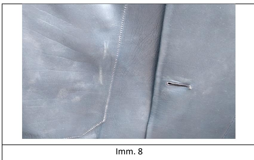
La tipologia di pelli maggiormente interessate da questa tipologia di difetto sono le pelli per abbigliamento o calzature poiché le elevate temperature che si raggiungono durante la stiratura dei capi o messa in forma delle calzature possono provocare la fusione dello zolfo che si trova in prossimità del fiore favorendone la migrazione e successiva cristallizzazione in superficie.
