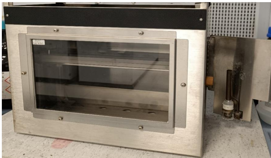
Fig. 1 Apparecchio per la resistenza alla propagazione orizzontale della fiamma.
