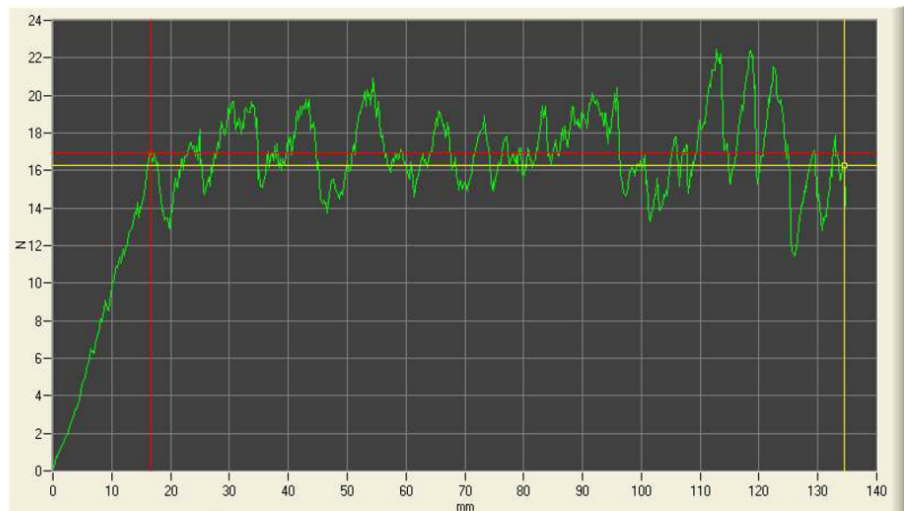
Figura 1: Prova di lacerazione e valutazione del diagramma dei picchi secondo ISO 3377-1
